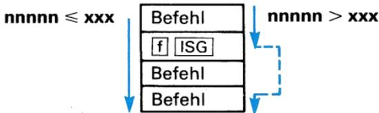
Bei jeder Ausführung von **f DSE** wird **nnnnn** um **yy** herabgesetzt. Danach wird abgefragt, ob **nnnnn** kleiner oder gleich **xxx** ist. Wenn ja, wird die nächste Zeile im Programmspeicher bei der Ausführung übersprungen.
