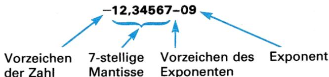
In der technischen Notation wird die erste signifikante Ziffer immer im Display angezeigt. Die nach dem Drücken von **[f]** **[ENG]** spezifizierte Zahl gibt die Anzahl der zusätzlichen signifikanten Stellen an, auf die die Anzeige gerundet werden soll. Zum Beispiel:
