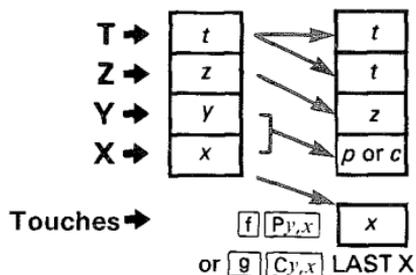
Le résultat,  $p$  ou  $c$ , est affiché dans le registre **X**, les contenus de la pile descendent d'un registre et le nombre d'éléments par arrangement ou combinaison est placé dans le registre **LASTX**.
