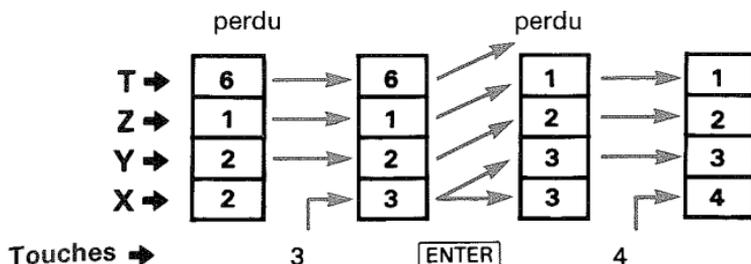
Les touches  $\boxed{R\downarrow}$  et  $\boxed{R\uparrow}$  effectuent une permutation circulaire des contenus des registres de la pile sans qu'aucune valeur ne soit perdue et la touche  $\boxed{x\approx y}$  permute les contenus des registres X et Y. Si la pile contient les nombres 1, 2, 3 et 4 les touches  $\boxed{R\downarrow}$ ,  $\boxed{g}$ ,  $\boxed{R\uparrow}$  et  $\boxed{x\approx y}$  donnent les résultats suivants:
