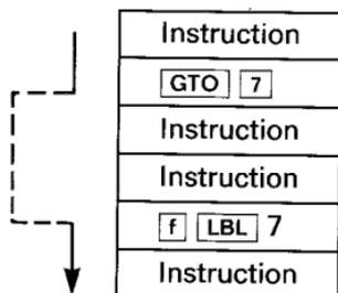
Lorsque le pointeur rencontre une instruction `GTO label` au cours d'un programme, le calculateur arrête momentanément l'exécution et cherche le label dans la mémoire (la recherche est conduite de la même façon que pour un positionnement manuel). L'exécution reprend à la première ligne rencontrée contenant ce label.
