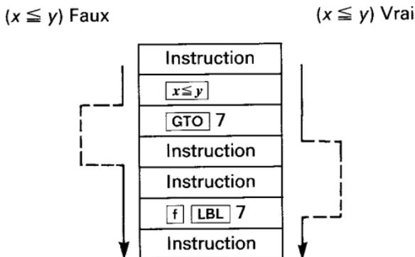
Lorsque le calculateur est en mode calcul, l'exécution de `GTO label` positionne le pointeur sur le label spécifié – il n'y a pas d'exécution. Cette caractéristique est particulièrement pratique lorsque vous désirez visualiser ou modifier les lignes qui suivent un certain label.
