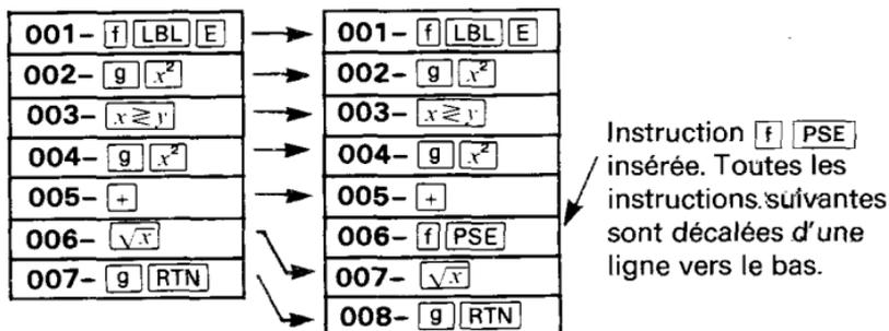
L'insertion suivante ayant lieu à la ligne précédente, il est plus rapide d'utiliser BST que GTO pour positionner le pointeur.
