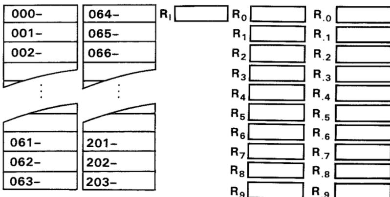
La répartition de base de la mémoire correspond à 63 lignes de programme et à 20 registres de données, plus le registre I. Le calculateur convertit automatiquement au fur et à mesure des besoins chaque registre de stockage en sept lignes de programme. La conversion commence à R<sub>9</sub> et finit à R<sub>0</sub>.
