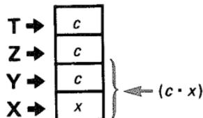
2. Le résultat du calcul est affiché dans X et les contenus de la pile descendent d'un registre.
