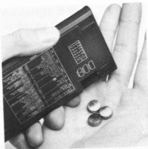
5. Insérez trois nouvelles piles dans le compartiment, le côté *plat* (marqué +) vers le patin caoutchouc le plus proche, la pile à l'*opposé* de ce patin (voir figure ci-contre).
