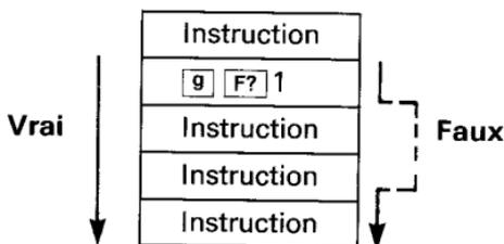
Un indicateur armé par un ordre **[g] [SF]** n, le reste jusqu'à effacement par un ordre **[g] [CF]** n ou réinitialisation de la mémoire permanente.
