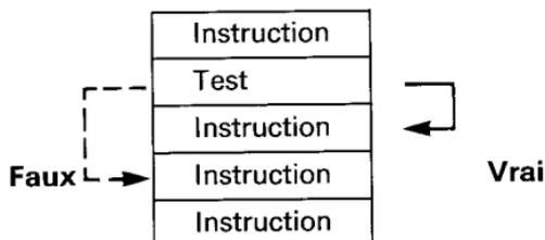
Les tests du HP-11C comparent le contenu du registre **X** à celui de **Y** ou à zéro:
