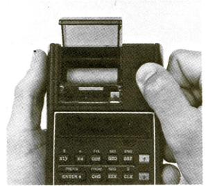
2. Wickeln Sie vor dem Einsetzen der neuen Rolle die ersten zwei oder drei Windungen ab und überzeugen Sie sich davon, daß sich auf dem Rest der Rolle keine Klebstoffrückstände mehr befinden.
