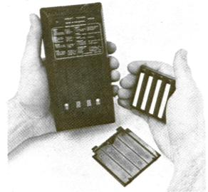
4. Setzen Sie den neuen Batteriesatz so ein, daß die Batteriepole auf die Kontakte zu liegen kommen und rasten Sie den Batteriefachdeckel dann mit leichtem Druck ein.
