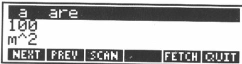
Die oberste Zeile enthält die Abkürzung der gewählten Einheit, im vorliegenden Fall **a**, welcher der vollständige Name **are** folgt. **are** ist die erste Einheit des alphabetisch geordneten Katalogs. Die zweite Zeile zeigt den Betrag der Einheit in SI Basiseinheiten, die in der dritten Zeile erscheinen. Insgesamt wird aus der Anzeige ersichtlich, daß **are** durch **a** abgekürzt wird und der Größe von 100 Quadratmetern entspricht.
