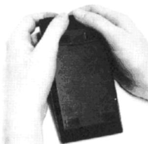
6. Agora vire a calculadora para cima, ligue-a para se assegurar de que a bateria foi instalada adequadamente. Se o visor não se acender, certifique-se de que a bateria foi colocada corretamente na calculadora.
