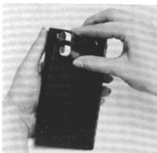
5. Setzen Sie den Batteriefachdeckel ein und schieben Sie ihn in seine ursprüngliche Lage.
