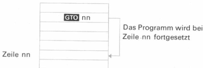
Eine **GTO**-Anweisung dieser Art wird als unbedingter Sprung bezeichnet. Der Sprungbefehl zu der angegebenen Programmspeicherzeile wird immer unbedingte ausgeführt. Später werden Sie erfahren, wie eine von einer Bedingung abhängige Anweisung in Verbindung mit der **GTO**-Anweisung zu einer bedingten Programmverzweigung führt, also einer Verzweigung, die von einer Abfrage abhängt.
