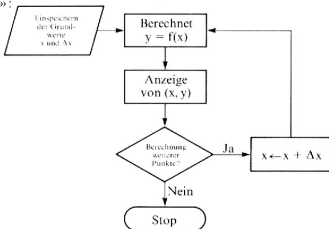
Das hier verwendete Programm veranschaulicht diesen Vorgang anhand einer etwas abweichenden Aufgabe. Wir wollen das Problem lösen, wie man die Flugbahn eines im Winkel  $\theta$  zur Horizontalen und mit der Geschwindigkeit  $v$  hochgeworfenen Steines berechnet. Wenn man die Luftreibung vernachlässigt, können die  $x$ - und  $y$ -Koordinaten des Steins in Abhängigkeit von der Zeit  $t$  mit folgenden Formeln berechnet werden:
