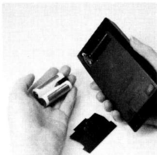
4. Mettez en place la nouvelle batterie dans le calculateur. Celui-ci ne fonctionnera que si la batterie est bien à sa place.
