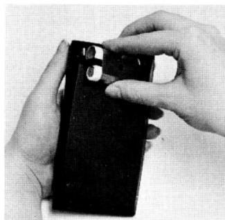
5. Introduisez la porte du logement de la batterie et faites-la glisser pour la remettre en place.
