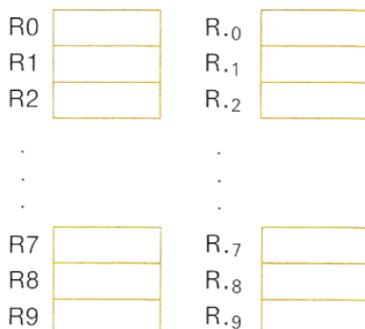
La répartition de base de la mémoire correspond à 70 lignes de programme et à 20 registres de données, plus le registre I. Le calculateur convertit automatiquement au fur et à mesure des besoins chaque registre de stockage en sept lignes de programme. La conversion commence à R<sub>9</sub> et finit à R<sub>0</sub>.
