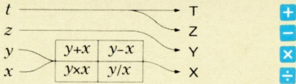
Lassen Sie uns den «Stack» für die Lösung von  $(3 \times 4) + (5 \times 6)$  beobachten. Die verwendeten Tasten werden über den eingekreisten Schrittnummern ① bis ⑨ angezeigt. Über den Tasten sehen Sie die Register X, Y, Z und T nach Tastendruck.
