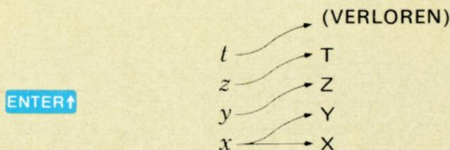
Wenn Sie **+** drücken, wird *X* zu *y* addiert und der gesamte «Stack» fällt nach unten, um das Ergebnis in X anzuzeigen. Das gleiche gilt für **-**, **×** und **÷**. Wenn immer der «Stack» fällt, wird *t* in T und Z dupliziert und Z fällt nach Y.
