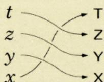
**Beispiel:** Laden Sie den Stack wie folgt: **1** **ENTER↑** **2** **ENTER↑** **3** **ENTER↑** **4**. (So sieht jetzt der Stack aus:  $X=4$ ,  $Y=3$ ,  $Z=2$  und  $t=1$ ). Um alle Register überblicken zu können, drücken Sie **R↓** viermal. Das vierte **R↓** bringt den Stack in seine Ausgangslage zurück. ( $X=4$ ,  $Y=3$ ,  $Z=2$ ,  $t=1$ ).
