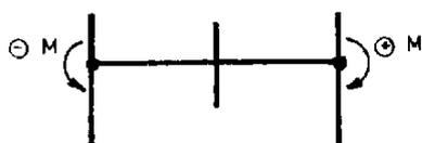
An *außenliegenden* Rahmenknoten können über die Momenteneingabe des unter diesem Knoten anschließenden Stieles Knotenmomente berücksichtigt werden, indem das Moment im Abstand der Stiellänge  $a = L$  eingegeben wird. Für Knoten an der *linken* Rahmenseite erfolgt aufgrund der dargestellten Belastung die Momenteneingabe mit *negativem* Vorzeichen (Bild 12).
