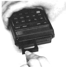
3. Stecken Sie das Anwender-Modul mit dem Etikett nach unten in eine beliebige Buchse, wie nebenstehend gezeigt. Anwender-Module müssen immer **nach** dem letzten Speichererweiterungsmodul eingesteckt werden. Die Nummern der Anschlußbuchsen sind nebenstehend angegeben, außerdem noch, der Bequemlichkeit halber, auf der Rückseite des Rechners.
