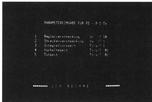
Bild 7.4 Parameter-Eingaben für PD-Regler und P-I-T<sub>t</sub>-Strecke beim Nyquist-Kriterium
