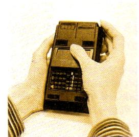
2. Faites pression sur le rebord du support de piles.
