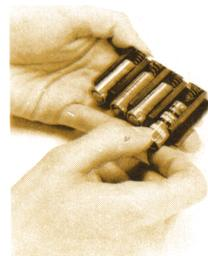
4. Observe el diagrama dentro del compartimento de las baterías. Este le indicará la forma en que deben insertarse. Coloque las nuevas baterías y *observe cuidadosamente la posición de cada una de ellas*. Si se coloca equivocadamente alguna de ellas, la calculadora no encenderá.
