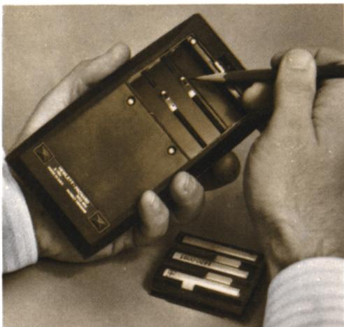
5. Introduire la batterie avec ses plots côté calculateur et en contact avec les ressorts du calculateur.
