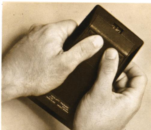
7. Verrouiller le couvercle du compartiment batterie en appuyant doucement et en faisant glisser les deux verrous.
