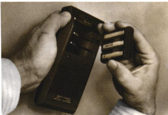
6. Engager le bas du couvercle du compartiment batterie dans la rainure et refermer ce couvercle.
