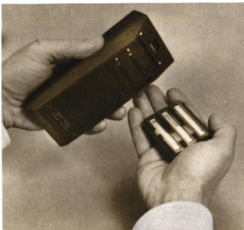
4. Vérifier que les ressorts du connecteur de batterie n'ont pas été aplatis accidentellement. S'ils le sont, les redresser, puis essayer à nouveau la batterie.
