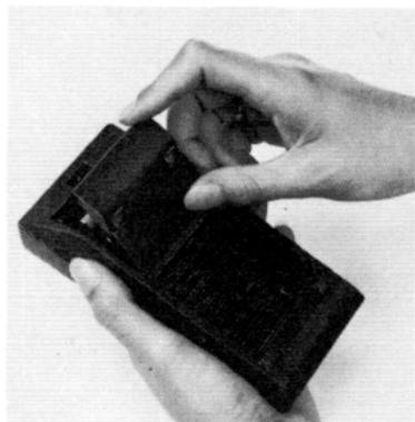
6. Batteriedeckel unter den unteren Rand des Gehäuses schieben.
