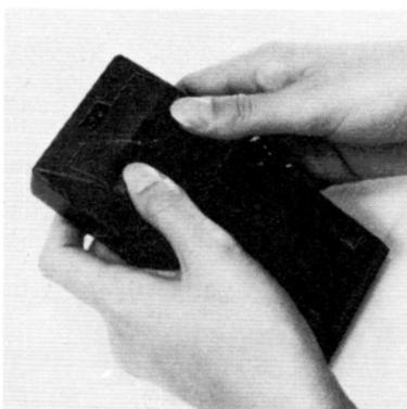
7. Verschließen Sie das Batteriefach, indem Sie die beiden Riegel wieder nach oben schieben.
