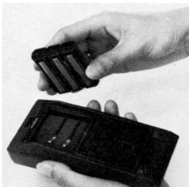
5. Setzen Sie die neue Batterie ein (achten Sie auf richtige Lage der Kontakte) und setzen Sie den Batteriedeckel auf.
