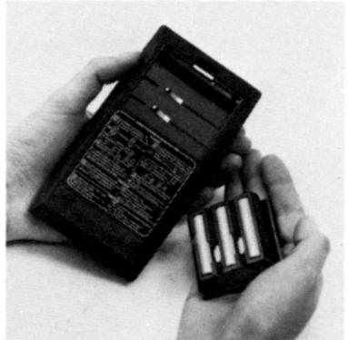
4. Kontrollieren Sie die mechanische Spannung der beiden Batteriekontaktfedern und biegen Sie sie gegebenenfalls etwas nach oben, um einem einwandfreien Kontakt mit dem Batteriesatz zu gewährleisten.
