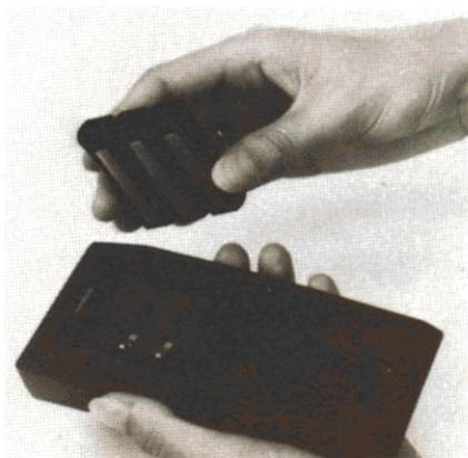
5. Coloque a bateria na calculadora, de tal maneira que seus contatos estejam de frente para a calculadora e que seja feito o contato com os conectores da bateria.
