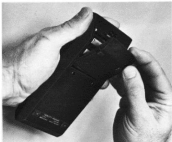
6. Batteriedeckel unter den unteren Rand des Gehäuses schieben.
