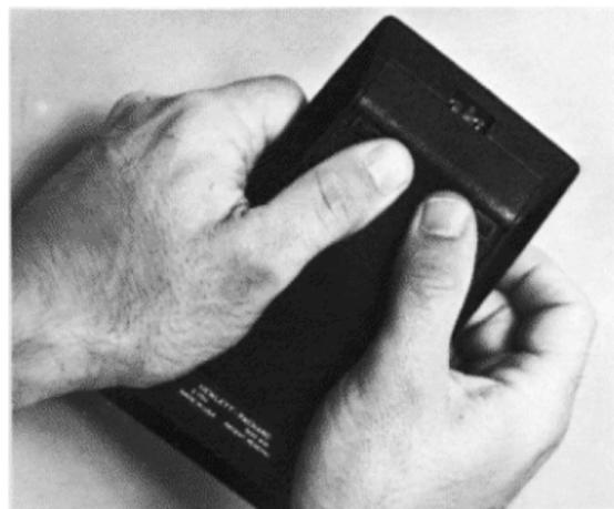
7. Verschließen Sie das Batteriefach, indem Sie die beiden Riegel wieder nach oben schieben.
