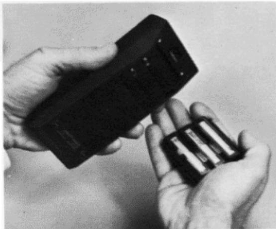
4. Kontrollieren Sie die mechanische Spannung der beiden Batteriekontakte und biegen Sie sie gegebenenfalls etwas nach oben, um einen einwandfreien Kontakt mit dem Batteriesatz zu gewährleisten.
