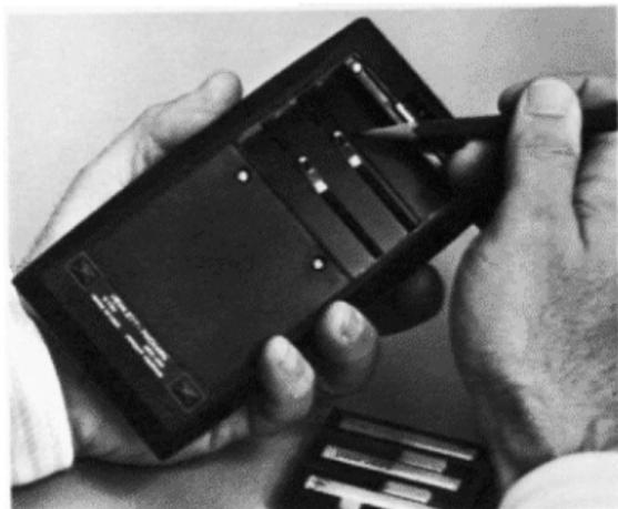
5. Setzen Sie die neue Batterie ein (achten Sie auf die richtige Lage der Kontakte) und setzen Sie den Deckel auf.
