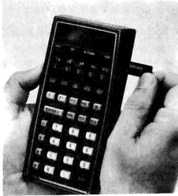
A l'arrêt du moteur, retirer la carte à gauche du calculateur et l'introduire dans la fente supérieure droite.
