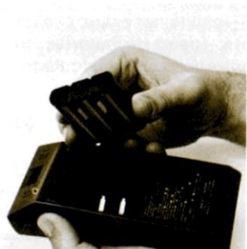
6. Coloque la parte superior de la tapa de la batería por detrás de la canaleta de retención y cierre la tapa.
