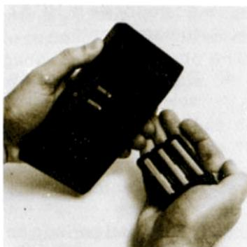
4. Observe si los resortes del conector de la batería se han aplastado hacia adentro en forma accidental. Si esto ha ocurrido, dóblelos hacia afuera y pruebe nuevamente la batería.
