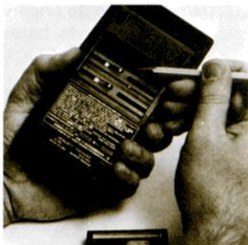
5. Coloque la nueva batería de modo que sus contactos estén frente a la calculadora y alineados con el resorte del conector.
