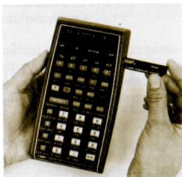
4. La pantalla de la calculadora va a indicar **Crd** para avisarle que se debe introducir la tarjeta del lado 2.
