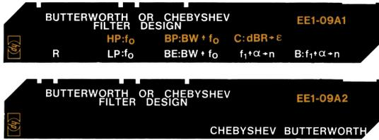
Dieses Programm berechnet Schaltelement-Werte für Butterworth- und Tschebyscheff-Filter zwischen gleichen Abschlußwiderständen. Einzugeben sind der Abschlußwiderstand, das Übertragungsverhalten (z.B. Tiefpaß, Hochpaß usw.), Dämpfung bei einer Frequenz außerhalb des Durchlaßbereichs und für das Tschebyscheff-Filter die zulässige Welligkeit im Durchlaßbereich.
