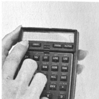
2. Entfernen Sie das Steckmodul oder die Verschlusskappe von Anschlußbuchse 4. (Wenn Sie dazu ein Speichererweiterungs-Modul entfernen müssen, ist sicherzustellen, daß dem HP-41C ausreichend Speicherplatz für die Datenspeicherung zugewiesen ist – die Ausführung von  064 stellt dies sicher.) Weitere Einzelheiten zu  können Sie in den Abschnitten 5 oder 7 des HP-41C Bedienungs- und Programmierhandbuchs nachlesen.
