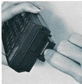
3. Connectez le lecteur au logement 4 conformément au schéma ci-contre, jusqu'au déclic.
