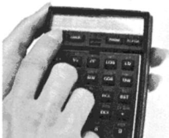
2. Remova o módulo conectável ou a tampa que esteja na porta nº 4. (Se você remover um módulo de memória, certifique-se de que a HP-41C tenha memória suficiente alocada para os registradores de armazenamento de dados - executando-se
