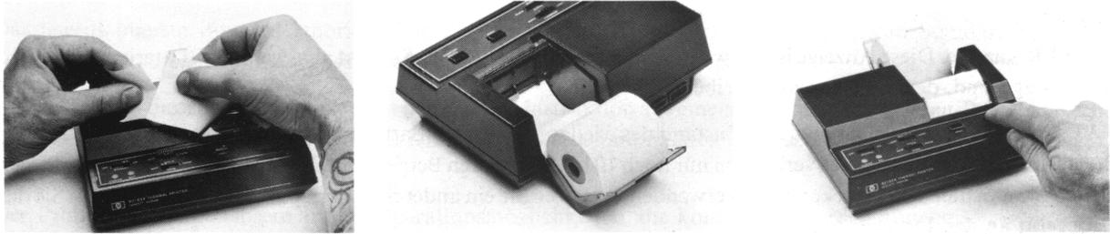
Falls das Papier richtig transportiert wird, aber kein Ausdruck erscheint, so sehen Sie bitte nach, ob das Papier richtig herum eingelegt ist. Das Papier muß von der Unterseite der Rolle her in den Schlitz des Druckermechanismus eingeführt sein.
