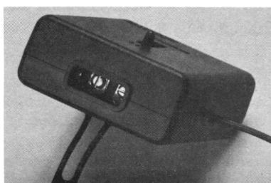
Um das Interface mit der Umschaltbox zu verbinden, wird das Ende des TV/Monitor-Kabels in die TV-Buchse des Video Interfaces gesteckt, dann wird das andere Ende in die Lautsprecherbuchse der Box gesteckt.
