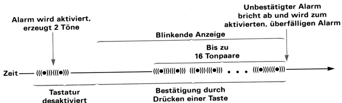
\* Bei gelöschtem Flag 26 – audio enable – wird kein Ton erzeugt. Näheres im Abschnitt 14, «Flags», im Rechnerhandbuch.
