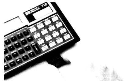
Zum Entfernen des Moduls ist das Modul mit den Fingernägeln am Griffstück auf der Vorderseite anzufassen und dann aus dem Einschubschacht herauszuziehen. Anschließend ist der Einschubschacht mit einer Modulattrappe zu verschließen, um die Kontakte vor Staub und sonstigen Partikeln zu schützen.
