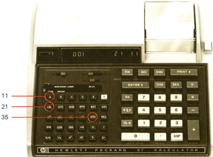
Dieses übersichtliche Verfahren der Codierung macht es leicht, einzelne Tasten anhand ihres Tasten-Codes zu identifizieren. Eine Ausnahme von dieser Regel bilden die Zifferntasten 0 bis 9, denen zweckmäßigerweise die Tasten-Codes 00 bis 09 zugeordnet sind. Ein Minuszeichen vor einem Tasten-Code besagt, daß diese Taste zum rechten Teil des Tastenfeldes gehört.
