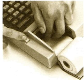
5. Schalten Sie den Rechner ein und drücken Sie die Papiervorschub-Taste so oft, bis die Papiervorderkante hinter der durchsichtigen Abreißkante sichtbar wird.
