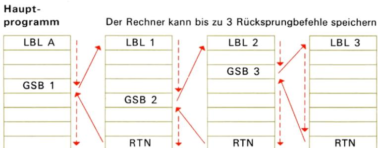
Wie Sie sehen, kann der Rechner noch aus einer dritten Unterprogrammebene zum Hauptprogramm zurückkehren. Wenn Sie allerdings versuchen, in der dritten Unterprogrammebene ein weiteres Unterprogramm aufzurufen, kann der Rechner anschließend ebenfalls nur 3 **RTN**-Anweisungen ausführen:
