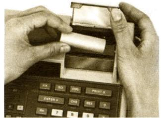
2. Wickeln Sie vor dem Einsetzen der neuen Rolle die ersten zwei oder drei Windungen ab und überzeugen Sie sich davon, daß sich auf dem Rest der Rolle keine Klebstoffrückstände mehr befinden.
