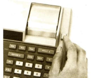
Wenn sich kein Papier im Rechner befindet, funktioniert zwar die Papiervorschub-Taste, der Drucker arbeitet aber nicht.
