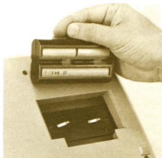
6. Batteriedeckel mit der den Verschlussriegeln gegenüberliegenden Seite unter den Rand des Rechnergehäuses schieben und beiklappen.
