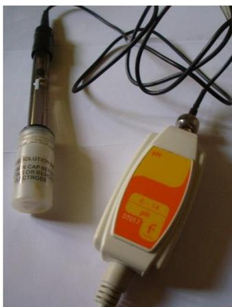
On étalonne d'abord le pH-mètre avec la solution tampon.
