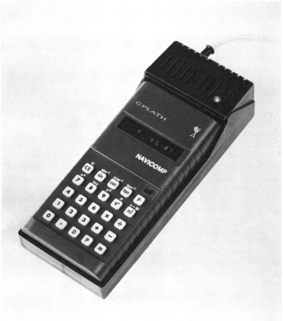
*Der Navicomp ist ein überaus leistungsfähiger – allerdings nicht ganz billiger – Navigationscomputer. Die Ephemeriden aller in der Navigation gebräuchlichen Gestirne sind bis 2049 vorausberechnet. In den Rechner ist eine Quarzuhr eingebaut. Das Ladegerät ist auch für 12 Volt lieferbar.*
