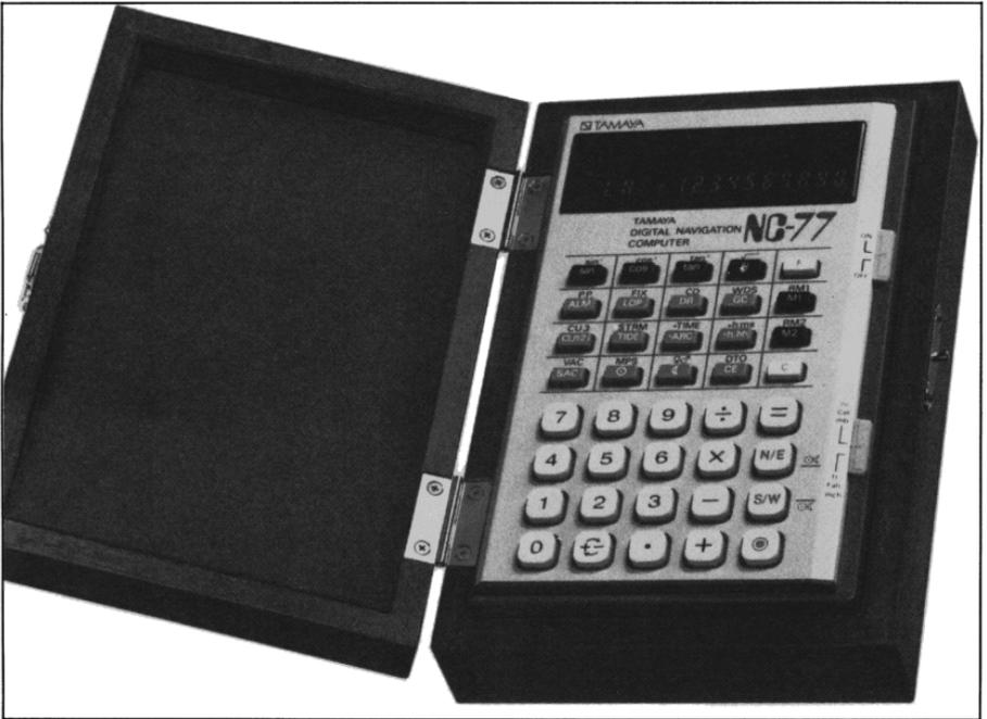
*Der NC-77 ist ein Spezial-Navigationsrechner, der als besonderen Gag die Sonnenephemeriden schon einprogrammiert hat, so daß Azimut und Interzept bei der Sonne auch ohne Nautisches Jahrbuch berechnet werden können. Auch eine Reihe von Programmen für die terrestrische Navigation ist vorhanden.*
