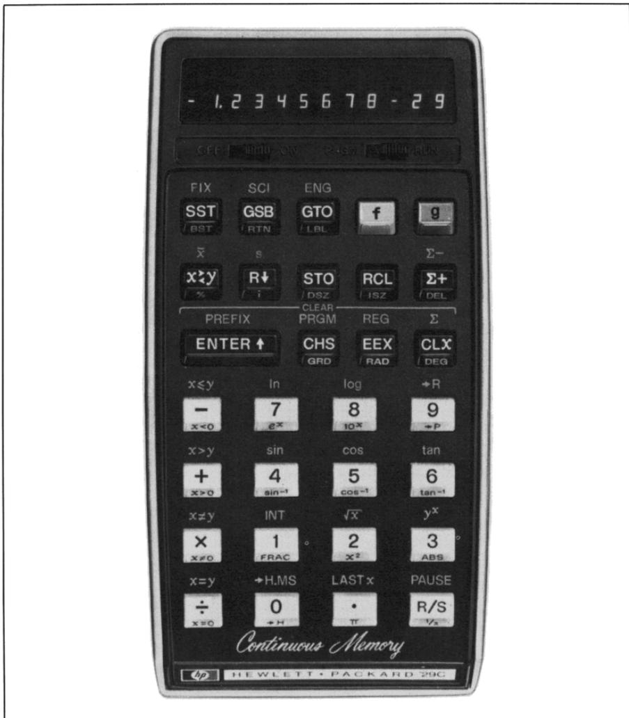
Der HP 29C ist mit 98 Schritten programmierbar. Wenn er ausgeschaltet wird, bleibt das Programm trotzdem erhalten, weil er über ein ewiges Gedächtnis verfügt. Wenn allerdings die 98 Schritte anderweitig benötigt werden, ist das alte Programm verloren. Aufzeichnungsmöglichkeit auf Magnetkarten besteht nicht.
