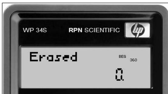
要将计算器关闭, 请按绿色键[h] (按下的时候会有一个小小的h显示在屏幕左上方), 然后按[EXIT]键 ([OFF]字样印在该键下方)。由于 WP 34S 具有关机保护存储器, 因此关机不会导致数据丢失。为了节省电池能量, WP 34S 将在闲置 5 分钟后自动关闭——再次打开时, 可以从上次中断的地方继续工作。
