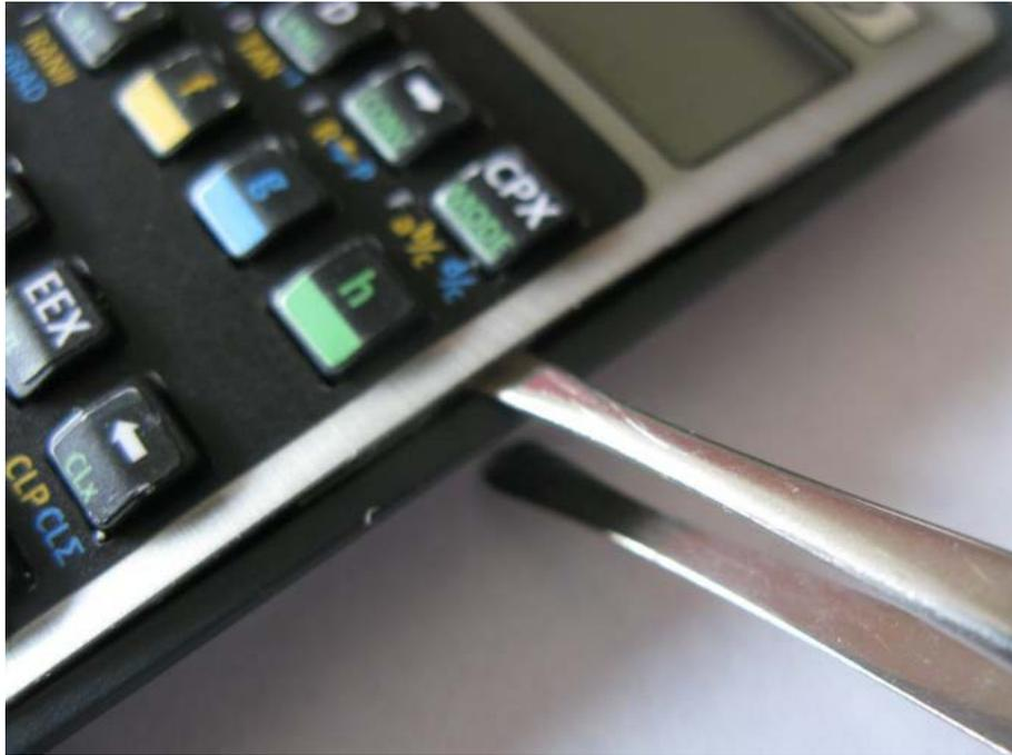
图 2：将工具插入银色正面和灰色框架之间，打开；先是侧面，再是上下。我用镊子来完成这个任务。
