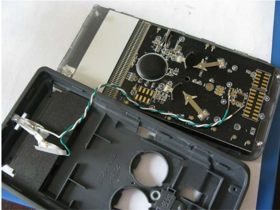
图 10：红外二极管和连接线就位。将它们做得更细或者更短，可以更容易地将它们放在箱子里。如果你有漂亮的收缩管或电工胶带，请务必使用。我只有透明胶带来做这项工作.....
