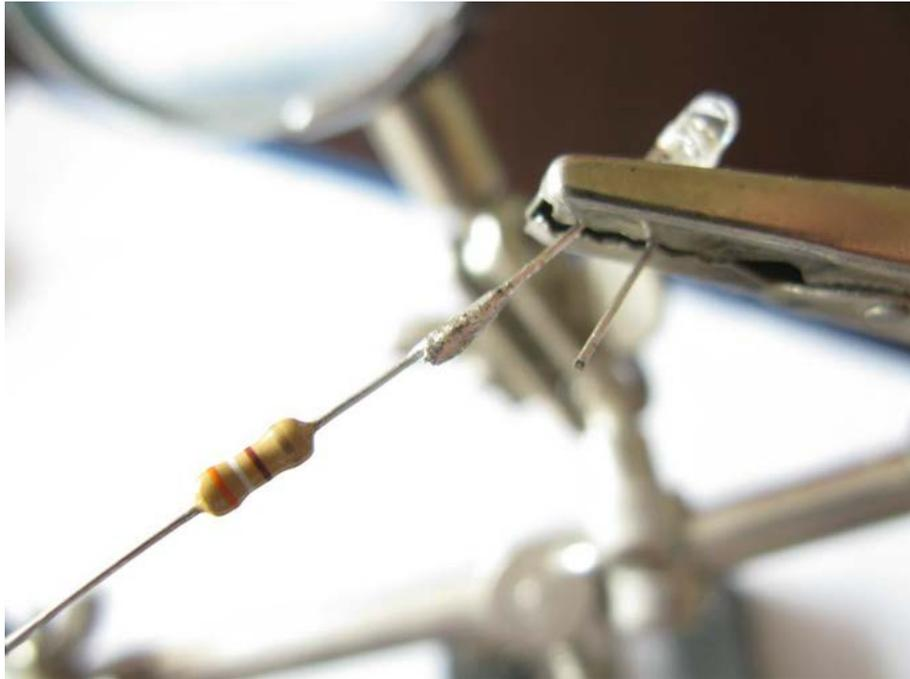
图 6：通过脚和长脚来识别二极管的阳极（长引线）和阴极（短引线）。尽量缩短红外二极管和电阻的管脚，可以比图上的更短，使整体尽可能的紧凑。将电阻焊接到红外二极管原来的长管脚。
