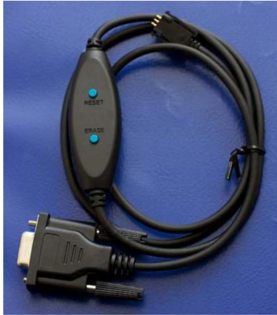
**警告：**只要这个数据线连在计算器上，它就会从计算器取电，消耗电池电力。如果计算器在刷机过程中碰巧死机了，计算器的处理器可能会在全速运行状态下，在您查找故障原因的时候消耗纽扣电池的电量。因此，请在暂时不需要联机的时候断开数据线。如果刷机比较频繁，用一个外置的 3V 电源性价比更高。连接外置电源务必小心，将‘+’连接到外侧电池触点，‘-’连接到内侧电池触点。刷机时电压最好在 3V，不过电压不低于 2.5V 亦可。
