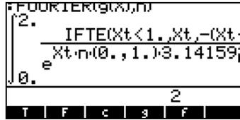
A calculadora retorna uma integral que não pode ser avaliada numericamente porque depende do parâmetro n. O coeficiente pode ainda ser calculador digitando sua definição na calculadora, ex.
