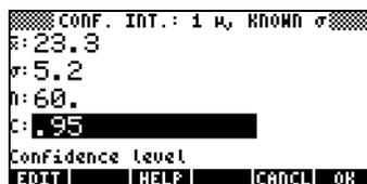
Pressione **2** para obter o visor explicando o significado do intervalo de confiança em termos de números aleatórios gerados por uma calculadora. Para rolar o visor resultante use a tecla de seta para baixo **↓**. Pressione **1** quando terminar de usar o visor de ajuda. Isto o levará de volta ao visor mostrado acima.
