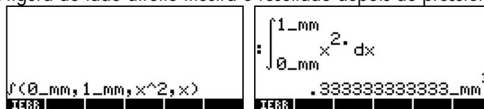
Se inserir a integral com o CAS configurado para o modo Exact, será solicitado a alterar para o modo Approx, portanto, os limites das integrais serão mostrados em um formato diferente conforme mostrado aqui:
