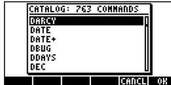
Por exemplo, para  $\epsilon/D = 0.0001$ ,  $Re = 1000000$ , você pode encontrar o fator de fricção usando: DARCY (0.0001,1000000). No seguinte visor, a função  $\rightarrow$ NUM () foi usada para obter um valor numérico da função:
