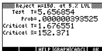
Rejeitamos a hipótese nula,  $H_0: \mu = 150$  contra a hipótese alternativa,  $H_1: \mu > 150$ . O teste t valor é  $t_0 = 5.656854$  com um valor  $P = 0.000000393525$ . O valor crítico de t é  $t_\alpha = 1.676551$ , correspondente ao crítico  $\bar{x} = 152.371$ .
