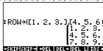
No modo RPN, coloque os n vetores nos níveis n+1, n, n-1, ..., 2 da pilha e o número n no nível 1 da pilha. Com esta configuração, função ROW $\rightarrow$  coloca os vetores como linhas na matriz resultante. A figura abaixo mostra a pilha RPN antes e depois de usar a função ROW $\rightarrow$ .
